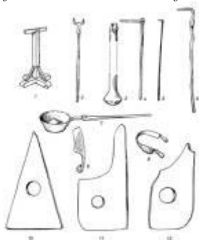
111. ábra. Tálasszerszámok (Hódmezővásárhely, Csongrád m.), melyeket a tálás mással készített: 1. inas; 2. deszkarakó szigony; 3. dupóvas; 4–5. agyagvágó; 6. mustravas; 7. öntőkanál; 8. edényszedő vaskó; 9. agyagszelő; 10–12. fakés
