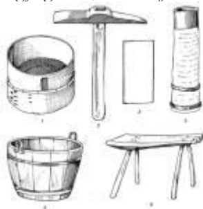
112. ábra. Tálasszerszámok (Hódmezővásárhely, Csongrád m.), melyeket a tálás készen vesz: 1. rézszita; 2. kővágó csákány; 3. padvakaró; 4. famozsár; 5. festékesdézsa; 6. öntőszék
