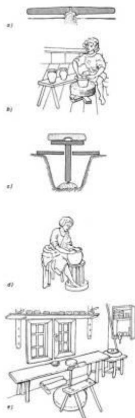
[565.] 115. ábra. Példák a korong fejlődésére: a) álló tengelyű kézikorong. Ur, i. e. 3500; b) álló tengelyű kézikorong (blokk-korong). Délnémet, 1470; c) forgó tengelyű kézikorong. Kréta. Rekonstrukció; d) álló tengelyű lábkorong (blokk-korong, oszlopos). Lengyel, 16. század; e) forgó tengelyű lábkorong (orsós korong). Pustina, Moldva, 20. század
